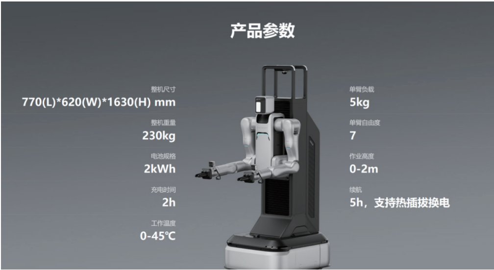
图11 智元远征A2-W柔性制造机器人产品参数 (来源:智元)
